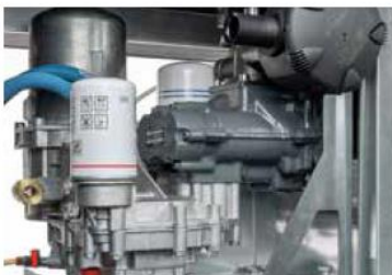
/// Filtrazione dell'olio /// Oil filtration
